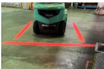
重機稼働中ライトにより視覚化
